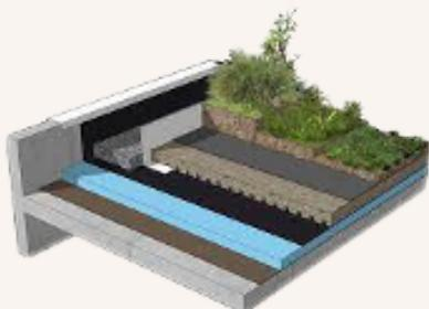
Ce type de terrasse est construit sur un toit **quasiment plat**, avec une pente située **obligatoirement entre 1 et 5%**.
